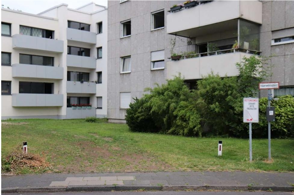
Abbildung 9 - Beispiel 1 - Kennzeichnung von Flächen für die Feuerwehr
